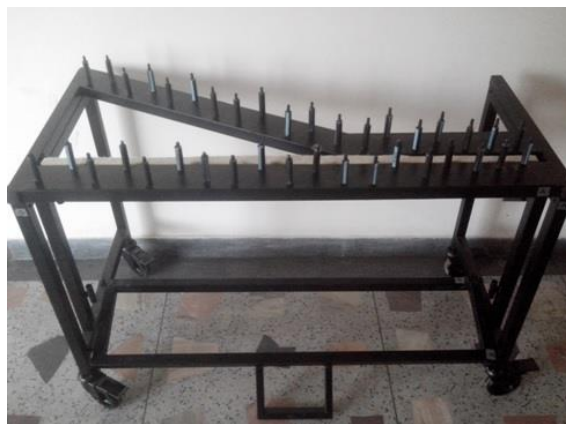
Fig. 2: Protótipo II – frame com mecanismo de abafamento sem as teclas.
