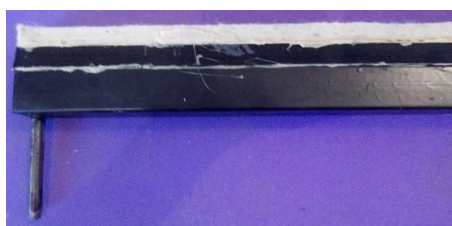
Fig. 12: Barra de abafamento.
