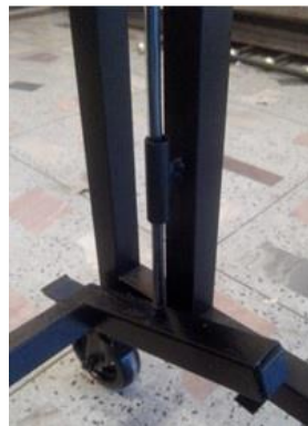
Fig. 16: Barra de articulação e eixos acionados através do pedal.
