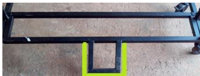
Fig. 3: Pedal acoplado à barra de articulação – Protótipo I.
