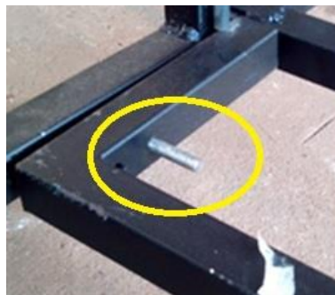
Fig. 7: Parafuso guia da barra de articulação e sustentação do pedal.
