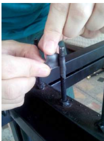
Figura 50 – Sixxen final: parafusos \frac{3}{4} revestidos de fita de auto-fusão.
