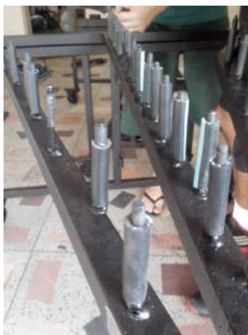
Figura 51 – Sixxen final: parafusos \frac{3}{4} com canaletas emborrachadas.
