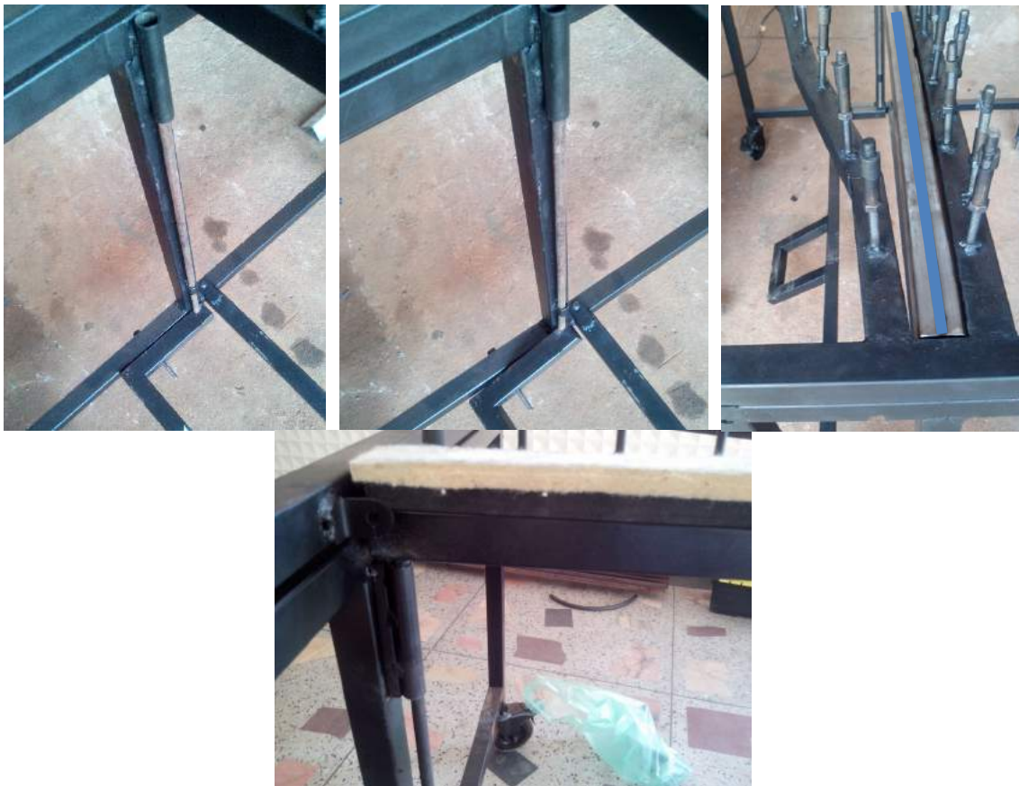
Figura 56 – Sixxen final: detalhes da barra de tração, da barra de abafamento, da barra com Feltro + E.V.A. para abafar as teclas sem causar ruídos.
