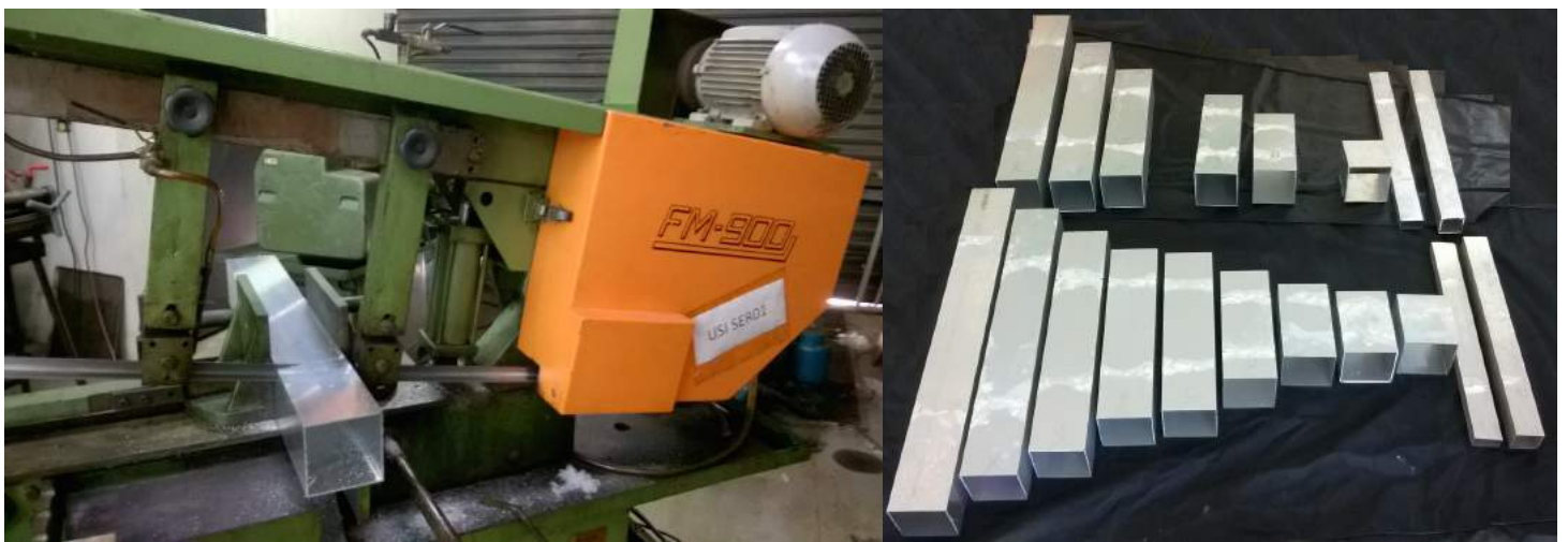
Fig. 40 – Perfis metálicos do segundo protótipo mostrando a etapa de corte e as regiões nodais.
