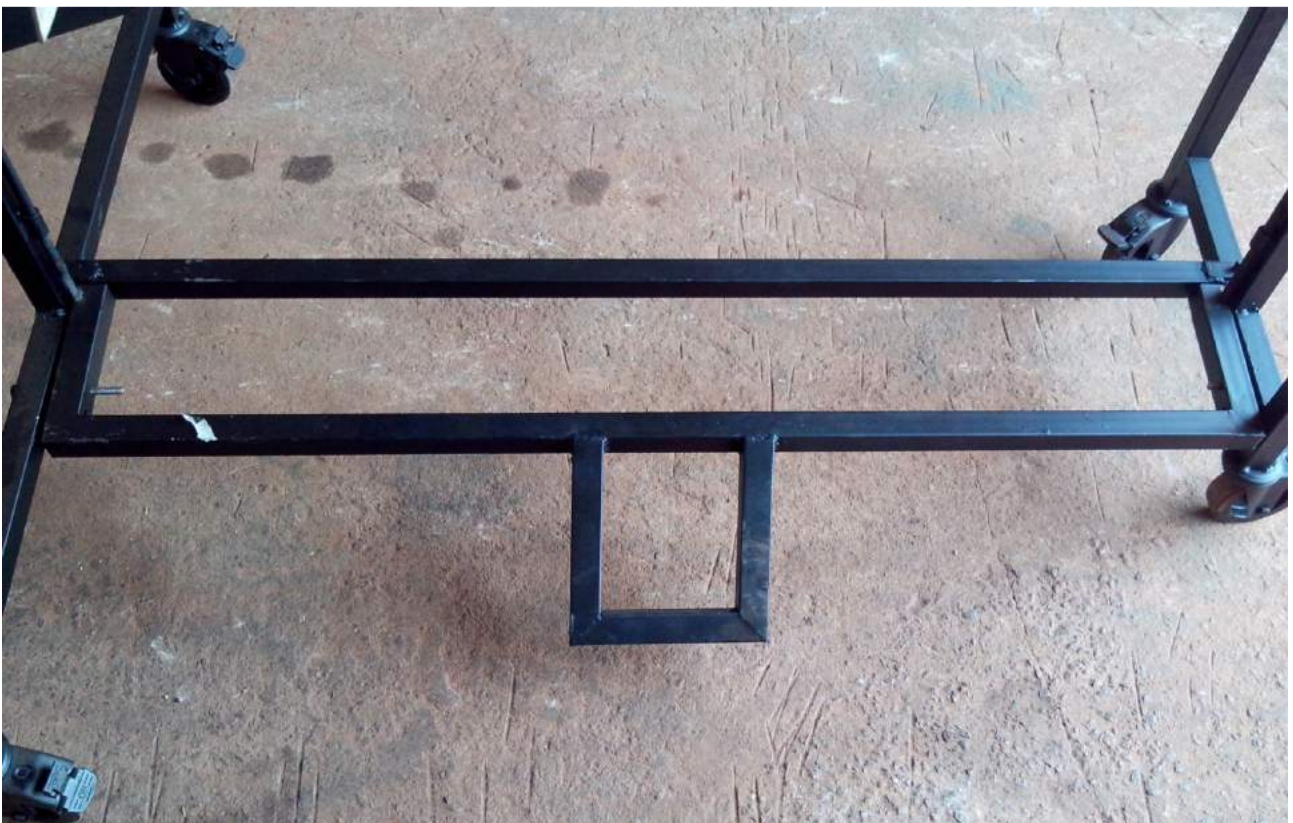
Detalhe do Pedal de abafamento, da barra de sustentação central, e das rodas.
