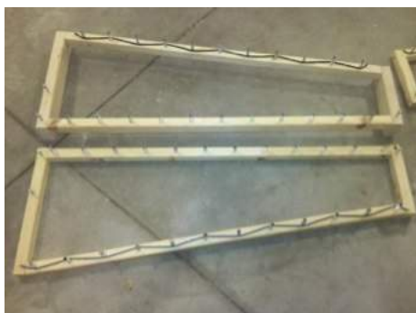
Fig. 2: Modelo de Sixxen do grupo Clocks in Motion, mostrando a diferença de corpos de sustentação para as lâminas mais próximas ao instrumentista e as mais afastadas.
