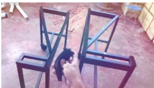
Figura 47 – E.V.A. e velcro para fixação das teclas ao quadro.
