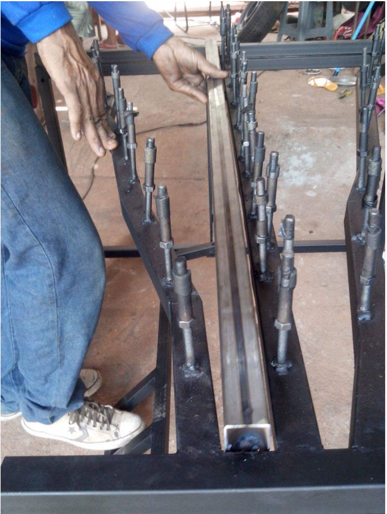
Vista lateral da barra de abafamento que é operado pelo pedal, e dos parafusos que sustentam as 19 peças de metal.
