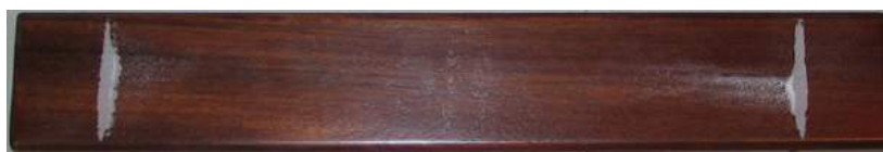
Figura 6 - Observe atentamente no centro da tecla onde um pequeno apinhado de sal se acumulou, marcando então o nó central. Fonte: http://www.lafavre.us/tuning-marimba.htm
